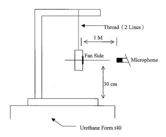
1 METER FROM MICROPHONE TO FAN INTAKE
